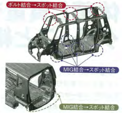
図5 各部の結合法の変化 ボルト結合やMIG結合を、スポット結合にできた。
