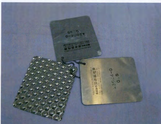
図41 深井製作所のエンボス加工薄板軽量化 (30) (日経ビジネスIT情報(Tech-On)より)
