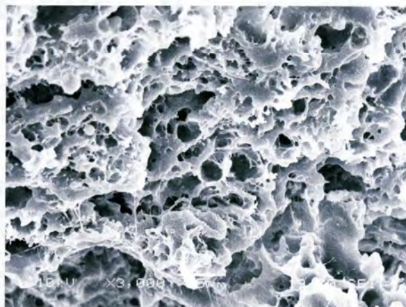
図 40 セルロースナノファイバー30%質量添加した PP 複合材 (*)
