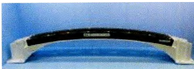
図 47 樹脂と鋼板のハイブリッドバンパー (36) (日経ビジネス IT(Tech-On より))
